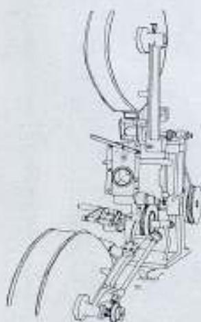
El crono VII, poco costoso, se recomienda para las explotaciones de gran importancia. El obturador no está ajustado delante del objetivo, como ocurre en otros modelos, sino que está situado entre la cinta y el objetivo. El enrollamiento de la película se efectúa mediante una cuerda metálica de transmisión; pero los engranajes para que requieren mayor solidez se utilizan las ruedas dentadas.
