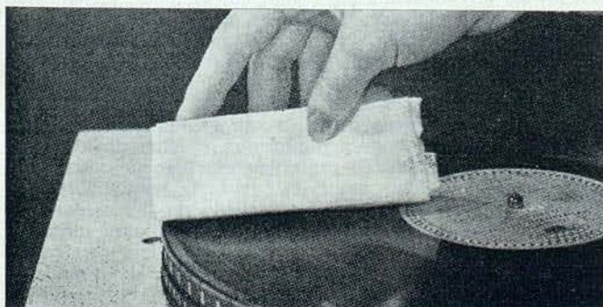
Fig. 2. Un pañuelo perfectamente limpio y levemente humedecido constituye un método eficiente para evitar los inconvenientes de las cargas electrostáticas.
