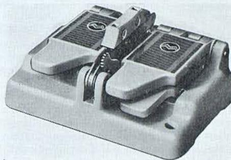
antimagnética, que no afecta en absoluto a la posible grabación de los films con que opera, debido a estar construida con un material especial. Por lo demás, está en la última línea de la técnica actual, ya que efectúa doble raspado en bisel o cuña, con lo que el empalme es por "testa", sin pérdida de fotograma y evitando el "claqueo" de los empalmes ante la cabeza magnética reproductora. Las cuchillas son de acero inoxidable y está prevista para 8 Normal y 16 mm., con pista magnética.
