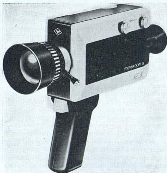
El transporte del film es mediante motor eléctrico alimentado por 4 pilas de 1,5 voltios, conectadas en la empuñadura. Dispone de las siguientes velocidades de filmación: 12, 18 y 24 fotogramas por segundo, así como toma de imagen por imagen. Está provista también de conexión para disparador de cable. La empuñadura es plegable.
