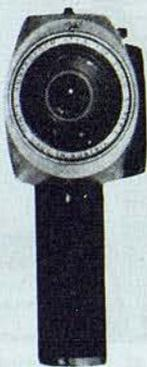
■ Motocámara lumino-dinámica Viennette "Súper 8" Zoom Reflex con objetivo Austrozoom 1:1.9 de 9 a 27 mm. ■ Visor Reflex y Servo-foco, (enfoque automático) a carga rápida. ■ Carga chasis súper 8 de 15 metros con regulación automática de la sensibilidad al introducirlo en la cámara. ■ Medición de luz a través del objetivo. ■ Velocidad de 18 a 24 imágenes por segundo. ■ Avance eléctrico del zoom con motor independiente. ■ Estuche maleta de lujo.
