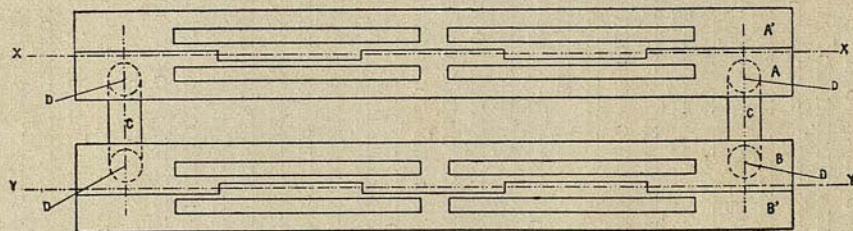
Fig. 28.—Paralelograma comprobador con cerraderas abiertas
