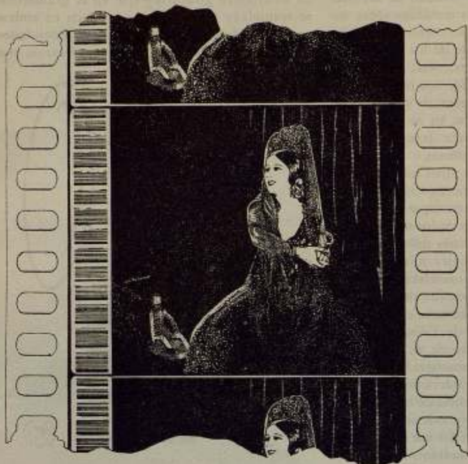
Fig. 2.—Trozo de fonofilm normal aumentado de tamaño para poder observar mejor la banda colocada a la izquierda donde están registrados los sonidos.
