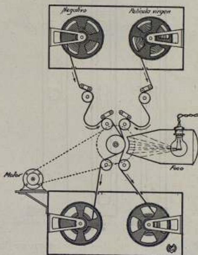
Fig. 1.—Esquema sinóptico de la obtención de positivas
