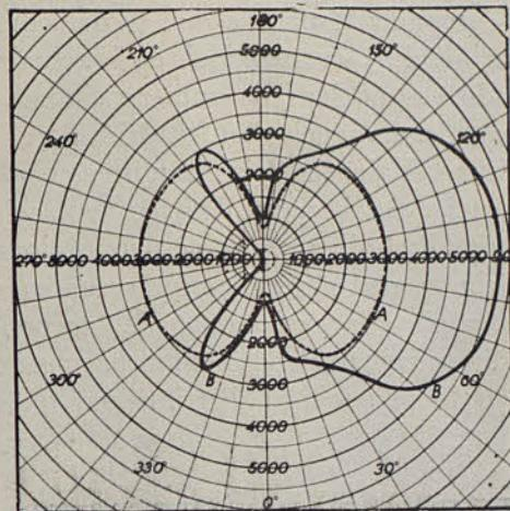
Fig. 8. — Curva luminica de una lámpara para proyección forma tubular para 900 vatios 30 voltios en un plano horizontal. — Curva A: Lámpara sola
