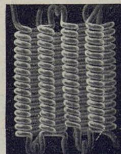
Fig. 7. — Reproducción del cuerpo lumínico con el reflejo de los segmentos de la espiral
