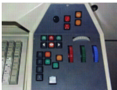
"Televisor" Color Master de FilmLab; llistat de llums, i controls de l'etalonatge
