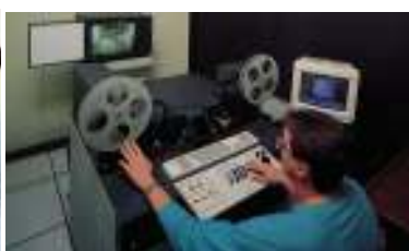
"Televisor" analitzador de color Hazeltine
