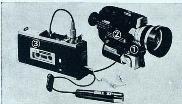
**Material:** (1) Tomavistas FUJICA equipado de generador de impulsos (2) y conectado a un magnetofón Fujica Puls Sync (3).
