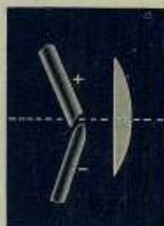
Posición de los carbones para la corriente continua.
