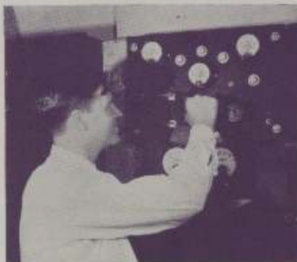
Poderoso amplificador del sonido a través del cual los murmullos se convierten en truenos reales, que se emplea en los escenarios a prueba de ruidos del estudio de la Paramount para disminuir el volumen de voz y darle al tono que se desea al ser grabada en discos o en el margen de la cinta de celuloide.
