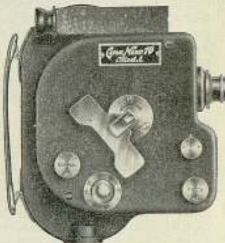
Motocámara, Modelo M. — Para bobinas de 15 a 30 metros, de films de 9,5 mm. Velocidades graduables de 8 a 32 imágenes por segundo. Marcha atrás. Dispositivo para sonoro. Objetivos intercambiables. Accionado indistintamente por motor o manivela.
