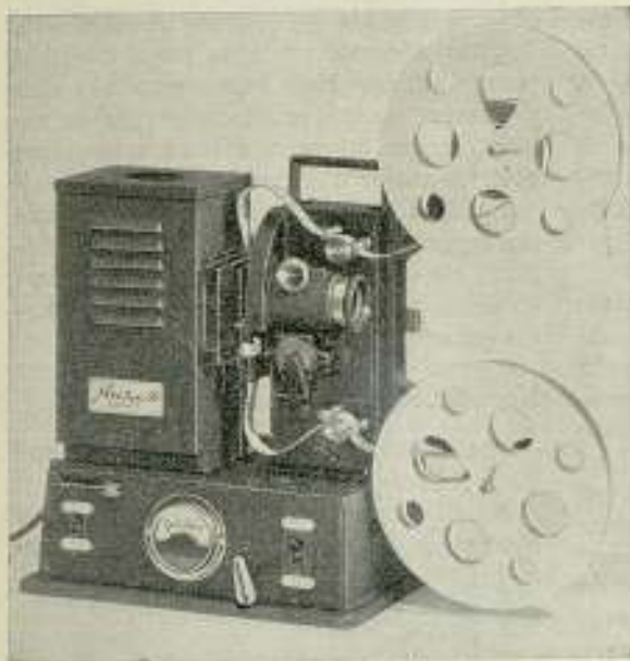
Proyector Nizo, modelo H. S. — Equipado con 2 motores, uno exclusivamente para la ventilación. Bombillas de 250, 400 y 500 w. Obturadores de 2 y 3 aspas conishies. Marcha atrás. Dispositivo para sonoro. Con un cambio de bloc permite proyectar películas «Leica» y «Contax» así como también positivos en vidrio.
