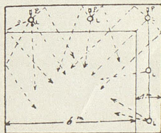
Fig. 5.—Dispositivo análogo al anterior; anchura 6 metros en vez de 3 y lámparas solamente en el techo y a un lado.
