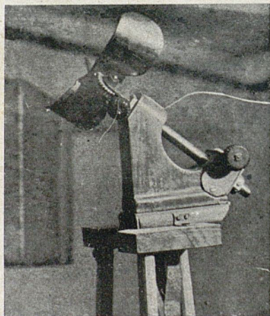
Pie con montura ecuatorial para seguir el movimiento aparente del cielo durante la exposición.
